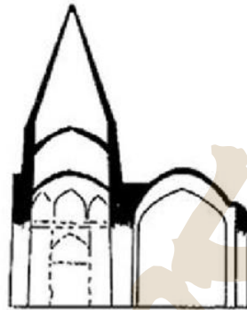
تصویر شماره ۲: گنبد رک سه پوسته و ساختار سازهای آن
